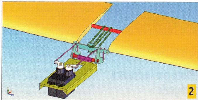
Voici, en vue 3D, le principe de commande des ailes à incidence intégrale : grâce à un mixage à l'émetteur, on obtient les fonctions de roulis (1) et de tangage (2) sans aucune gouverne venant perturber l'écoulement sur les ailes.
