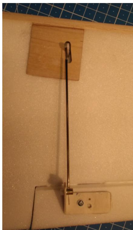
Réaliser deux guignols en plastique avec une assise assez importante pour la transmission des efforts (cornière plastique). Coller le guignol et assurer avec une petite platine en CTP 10/10 en vis à vis collée aussi et vissée à travers la gouverne.
