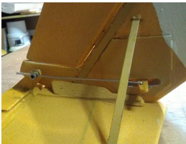
Réaliser un guignol en plastique avec une assise assez importante pour la transmission des efforts (cornière plastique). Coller le guignol et assurer avec une petite platine en CTP 10/10 en vis à vis collée aussi et vissée à travers la gouverne.
