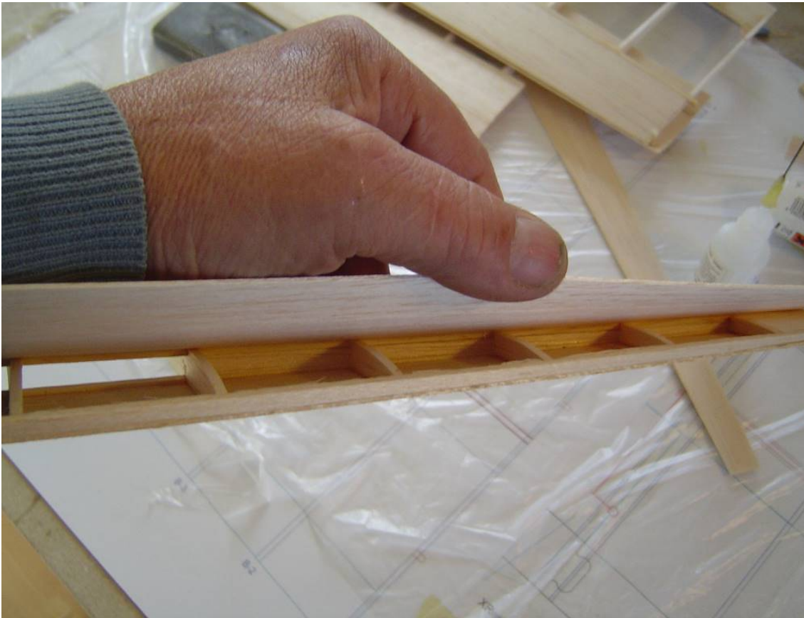
Verkleben der oberen Beplankung mit den Rippen
