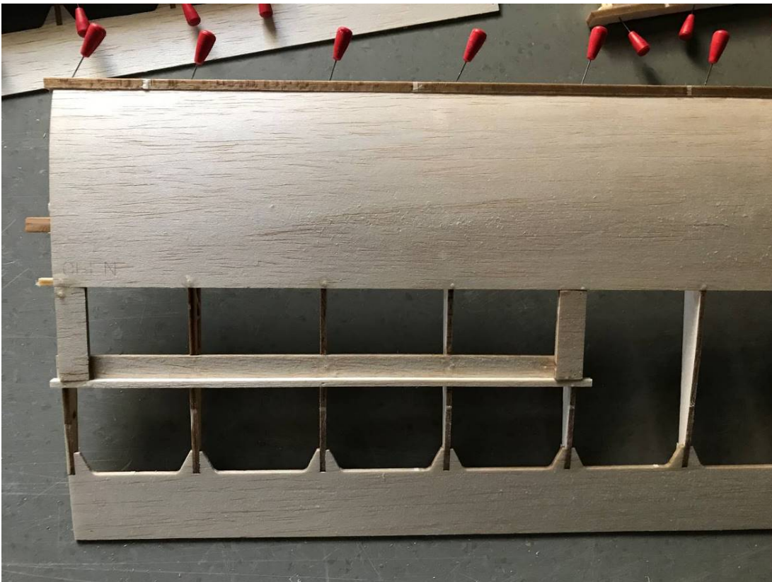
Angeklebte und fixierte Nasenleiste
