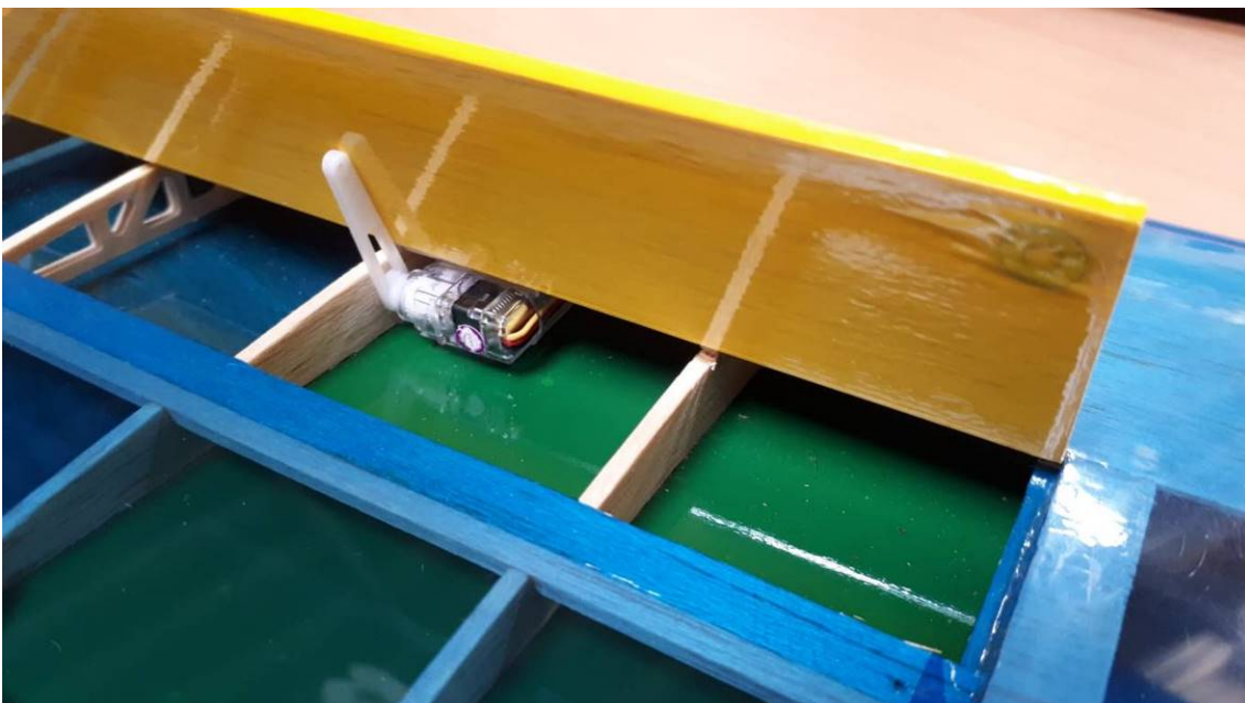
Anlenkung der Bremsklappe an der fertig folierten Fläche
