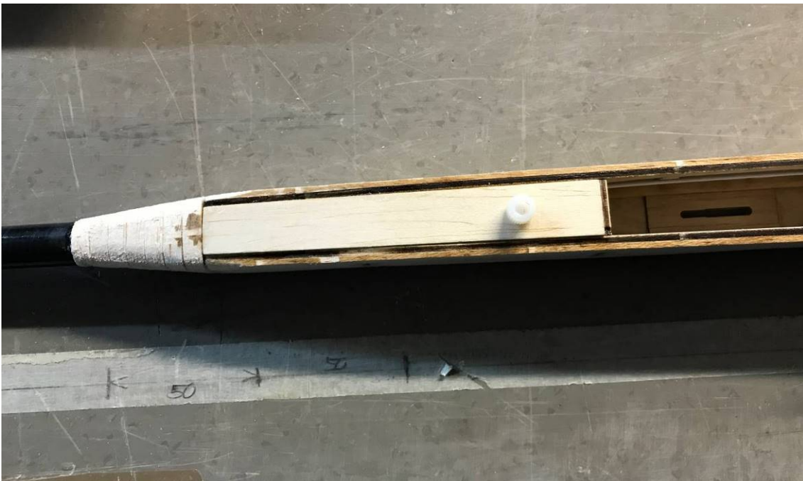
Rumpf hinten verschliffen
