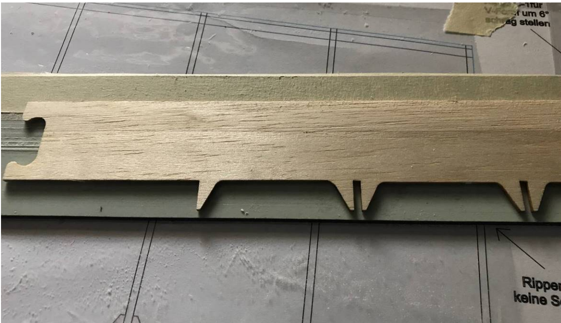
Endleiste fertig verschliffen
