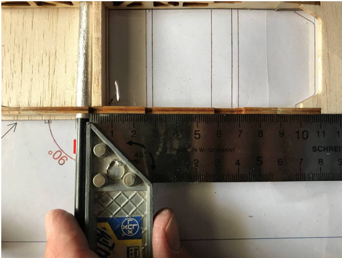
Ausrichten der Steckung
