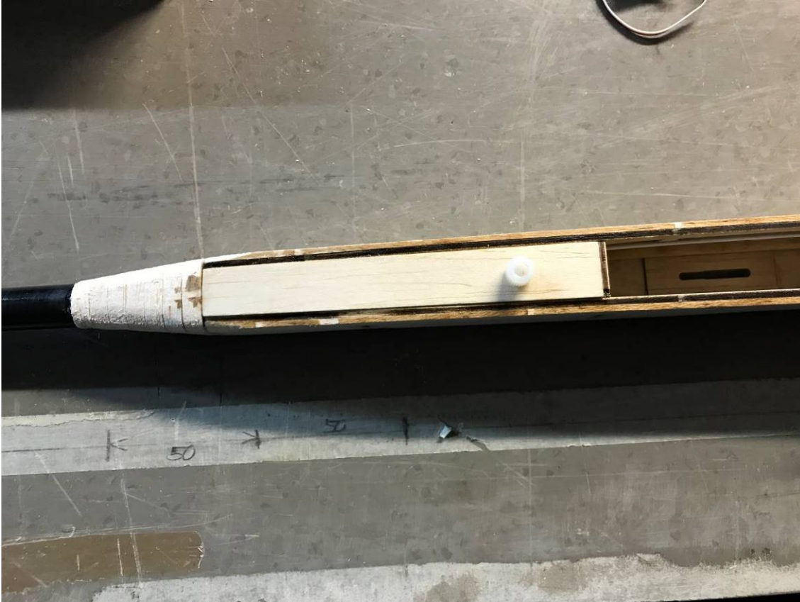
Verschliffener Übergang Rumpf- Rumpfrohr
