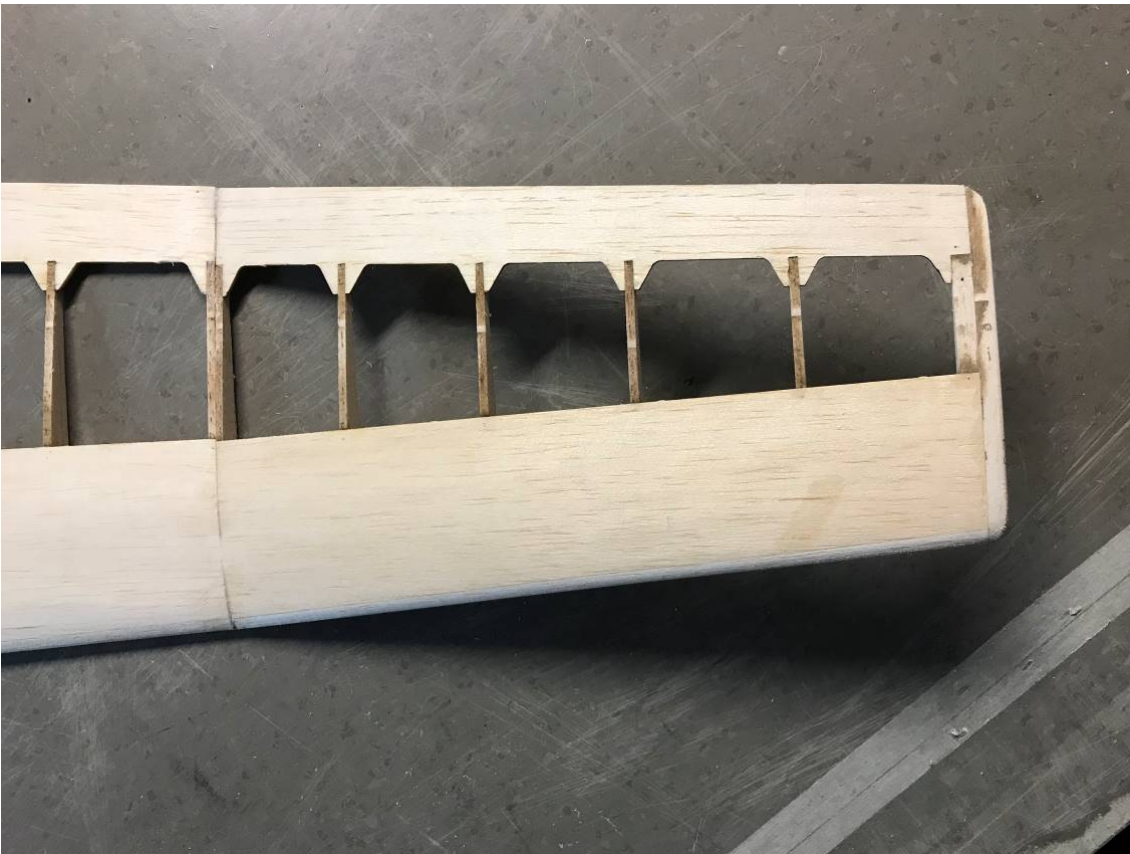
Verklebter Außenbereich von oben
