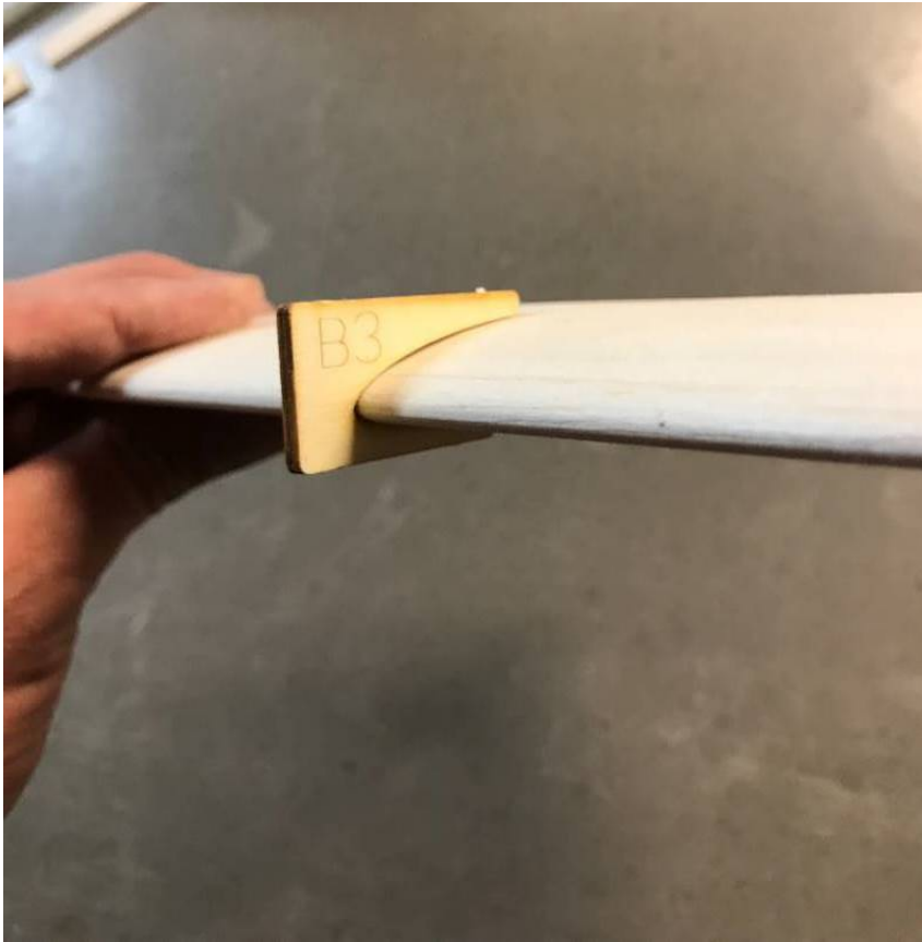
Verschleifen der Nasenleiste und Kontrolle mit Schablone
