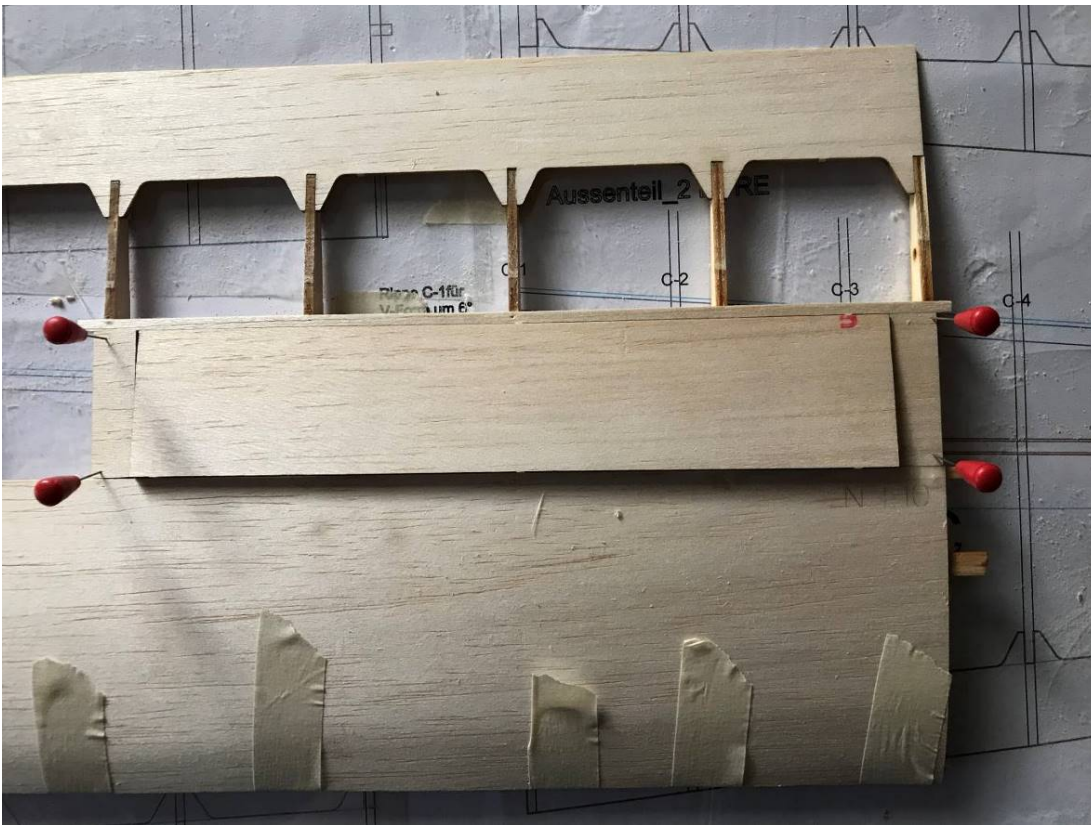
Einpassen der Klappe
