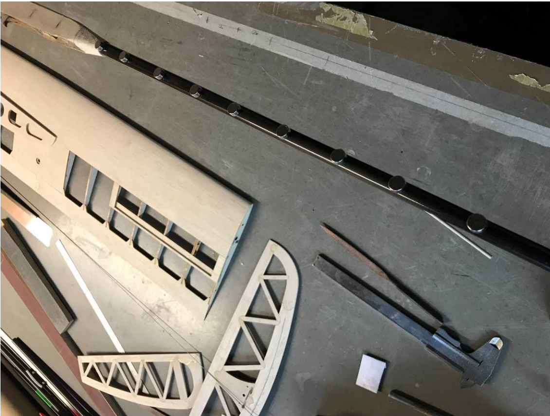
Verkleben der Bowdenzugrohre - mit Magneten fixiert
