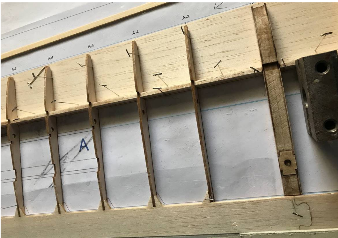
Bauteile fixiert und zum verkleben vorbereitet
