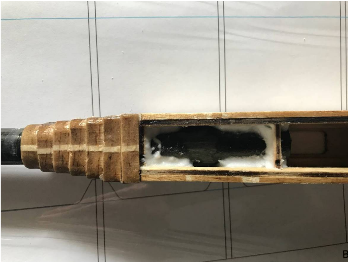
Rumpfrohr endgültig verklebt
