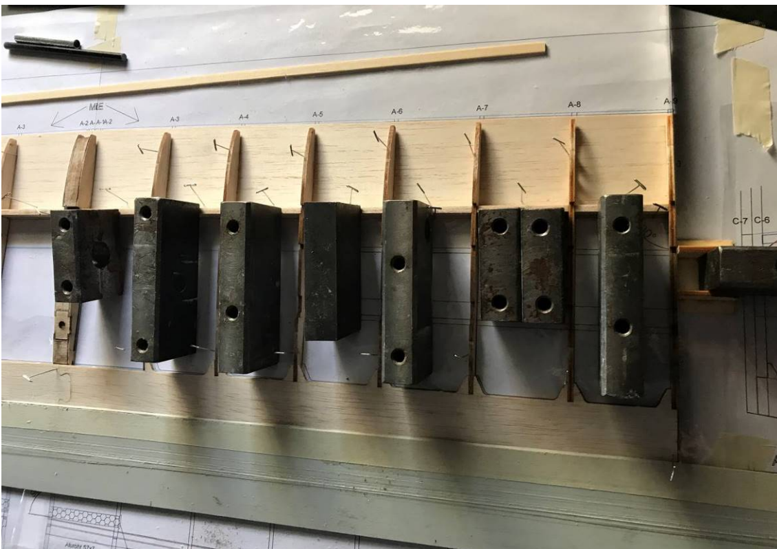
Rippen ausgerichtet und fixiert
