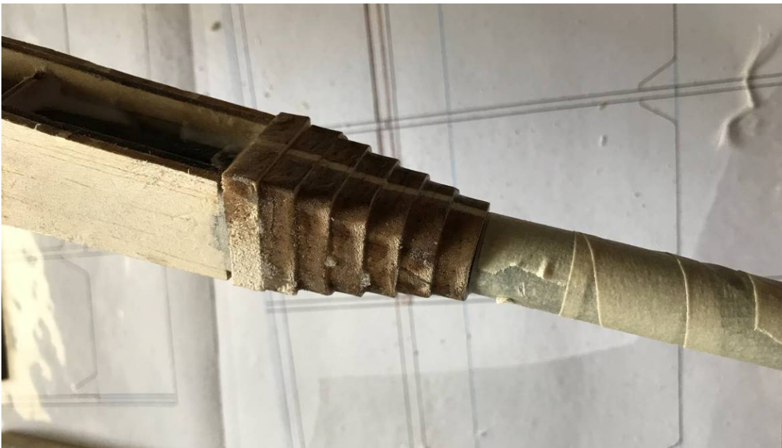
Rumpfrohrverkleidungen vor dem Verschleifen
