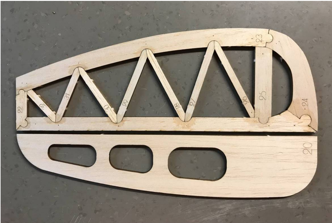
Seitenleitwerk vor dem Verschleifen
