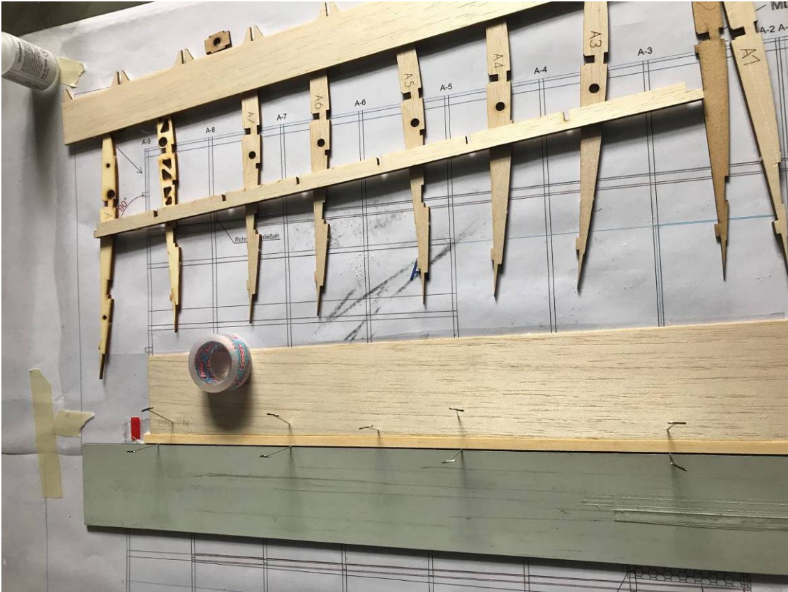
Verklebung unterer Holmgurt mit Beplankung (unten)
