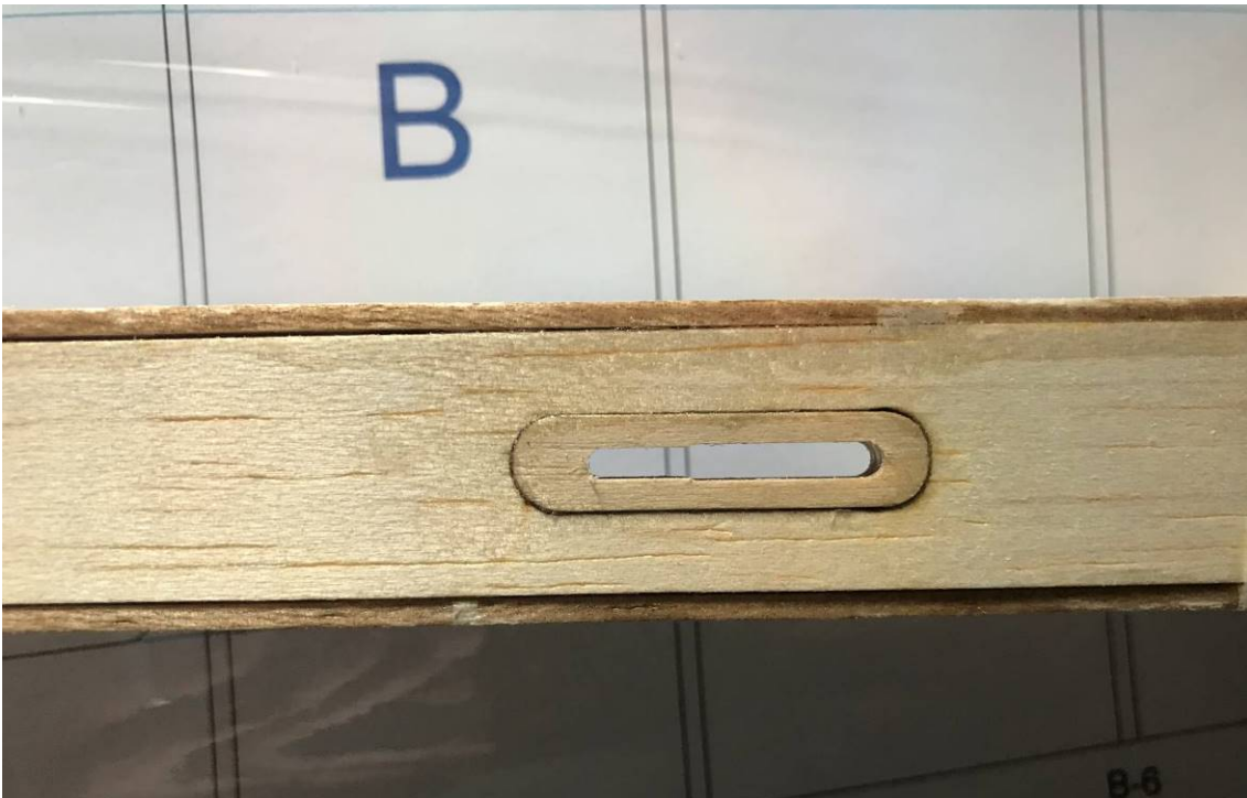
Hochstarthaken (temporär zerlegt und in Rumpfboden eingeklebt)
